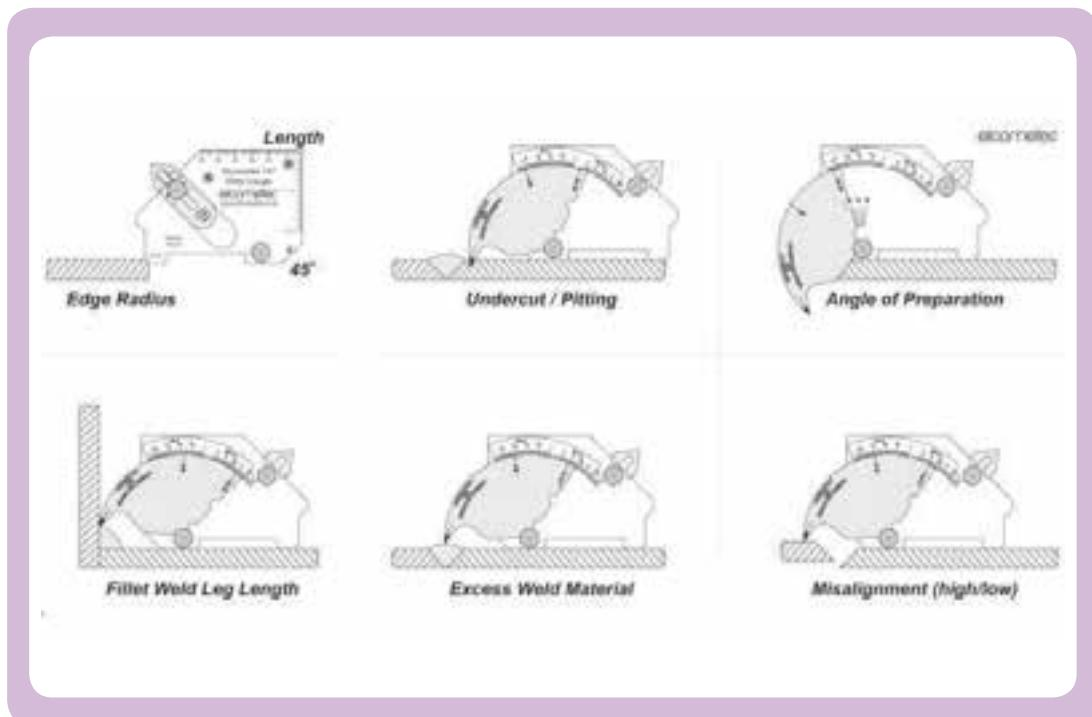
همان طور که پیشتر نیز گفته شد اکثر بازرسی‌های مربوط به مراحل قبل و حین جوشکاری نیز بر اساس بررسی‌ها و مشاهدات چشمی استوار است لذا ملاحظه می‌شود این نوع بازرسی چنانچه به موقع و از طریق افراد با تجربه صورت پذیرد بسیار کارآمد و موثر است. و به تجربه ثابت شده است؛ بسیاری از عیوبی که بعداً با روش‌های بازرسی پیشرفته و پرهزینه کشف می‌شوند، از طریق برنامه نظاممند بازرسی چشمی و کنترل‌های قبل، حین و بعد از جوشکاری به راحتی قابل آشکارسازی می‌باشند.
