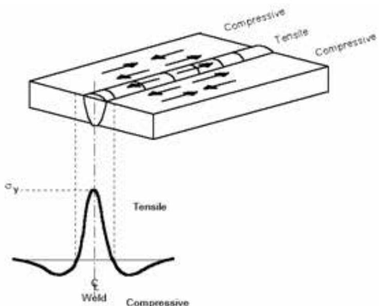
بنابراین تنشهای پسماند ناشی از جوشکاری روی خواص مکانیکی مثل استحکام و خستگی اتصالات جوشی تاثیر گذار است بطوریکه بر اساس بررسی های صورت گرفته در بعضی از سوانح بزرگ مربوط به سازه های جوشکاری (ریزش پلهای فلزی و یا دونیم شدن کشتی های ساخته شده با اتصالات جوشی) تنشهای پسماند ناشی از جوشکاری مهمترین عامل سانحه شناخته شده است. لذا بهتر است حد امکان طول مسیر جوش حداقل باشد و اتصال جوشی طوری طراحی شود که در محل های دور از محل های مرکز تنش و یا حتی المقدور در محل های نزدیک با تنش های فشاری قرار گیرند.
