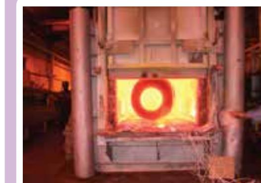
مدت عملیات تنش زدائی در مورد قطعات فولادی به‌طور معمول به ازاء هر اینچ ضخامت حدود یک ساعت است. برای قطعات پیشگرم شده اغلب تشن زدائی لازم می‌شود، همچنین قطعات پیچیده یا فولادهایی که میل زیادی به ترک خوردن دارند باید بلافاصله پس از جوشکاری و قبل از سرد شدن تا دمای پیشگرم، در کوره تنش زدائی قرار بگیرند.
