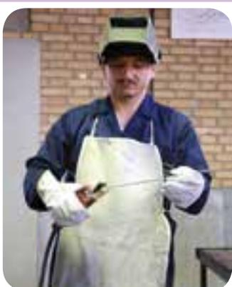
۳- یک عدد الکترود را مطابق شکل در دهانه انبر جوشکاری قرار دهید و چک کنید که لقی نداشته باشد.
