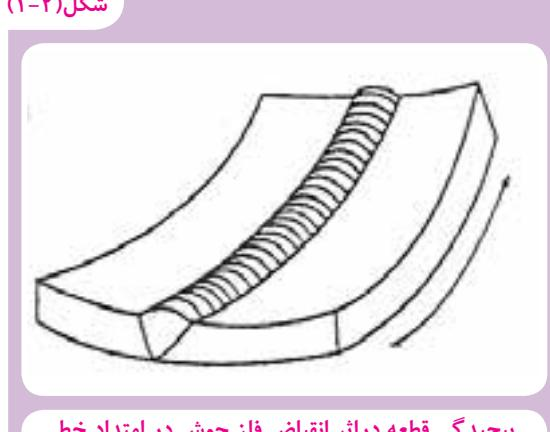
پیچیدگی قطعه در اثر انقباض فلز جوش در امتداد خط جوشکاری
