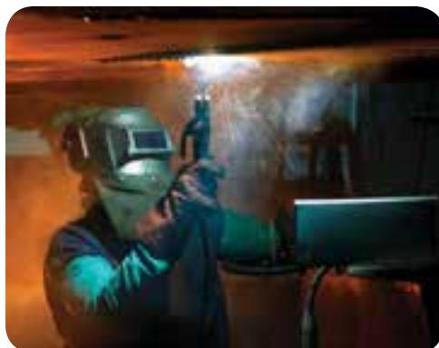
۳- قطعه کار را در وضعیت مناسب روی میز کار بیندید و با رعایت نکات ایمنی شروع به جوشکاری نماید.
