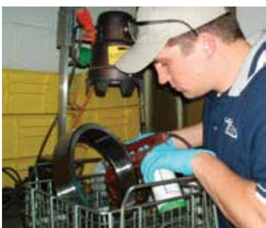
بازرسی با ذرات مغناطیسی، روش حساسی برای ردیابی عیوب سطحی و برخی نقصهای زیر سطحی (نژدیک به سطح) در قطعات دارای خاصیت فرو مغناطیسی است. پارامترهای اساسی فرآیند به مفاهیم نسبتاً ساده‌ای بستگی دارد. هنگامی که یک قطعه فرومغناطیسی، مغناطیس می‌شود، ناپیوستگی مغناطیسی که تقریباً در راستای عمود بر جهت میدان مغناطیسی واقع است، موجب ایجاد یک میدان نشتی قوی می‌شود. این میدان نشتی در رو و بالای سطح قطعه مغناطیس شده حضور دارد و می‌تواند توسط ذرات ریز مغناطیسی آشکار شود.
