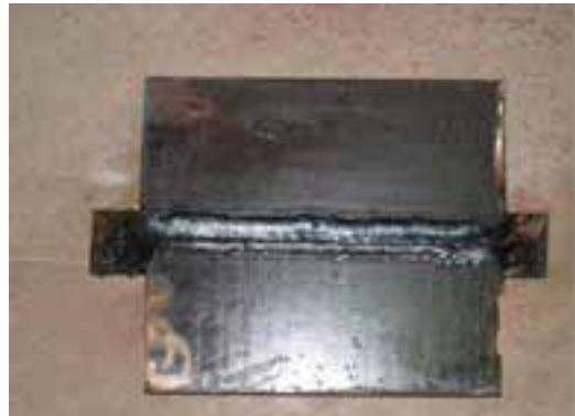
۲- سپس بوسیله مایع نافذ (penetrant) سطح موردنظر را می پوشانیم که میتوان این عمل را با اسپری نمودن نافذ و یا غوطه ور ساختن قطعه درون نافذ انجام داد. بر اثر خاصیت مویینگی نافذ به درون ترکها نفوذ میکند و برای اینکه از نفوذ آن اطمینان حاصل نماییم مدتی را صبر کرده (حدود ۳۰ دقیقه) و سپس
