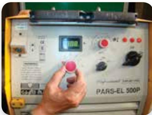
دقت کنید حرکت دست شما بدون نوسان و با سرعت مناسب باشد تا پهنهای جوش با اندازه مورد نظر ایجاد شود. و در انتهای خط جوش و هنگام قطع قوس الکترود را کمی به کار نزدیک کنید و پس از آنکه مکث در جهت عکس حرکت پیش روی از قطعه کار جدا کنید.
