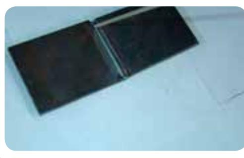
۲- قطعه کار را پس از مونتاژ به وسیله خال جوش یا با استفاده از چند لقمه نسبت به هم ثبیت نماید
