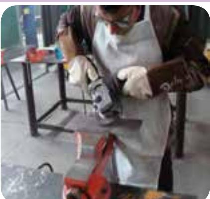
۳- قطعه کاری را مطابق نقشه انتخاب و پلیسه گیری نموده و نیز سطح آن را از زنگار و آلودگی های دیگر با استفاده از برس سیمی تمیز کنید
