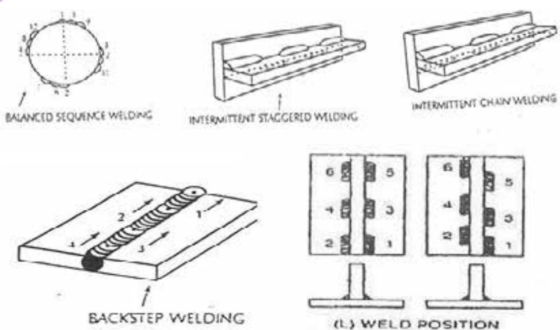
۱۰- طرح مناسب لبه مورد اتصال که اگر صحیح طراحی شده باشد می تواند بصورت فرضی مصالح جوش را در اطراف محور خنثی پخش کند و تا حد زیادی از میزان اعوجاج بکاهد.
