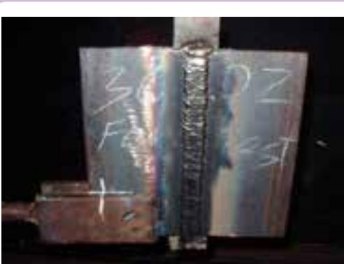
۴- در پایان کار قطعه کار را تمیز کنید و به کمک مریخ خود آنرا بررسی نمایید و در خصوص اجرای بازرسی چشمی قطعه گزارش تهیه کنید.
