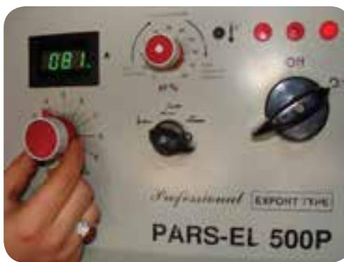
۴- دستگاه رکتی فایری را که برای جوشکاری با فرآیند الکترود دستی انتخاب شده با رعایت نکات ایمنی راهاندازی نمائید و آمپر مناسب را تنظیم کنید.
