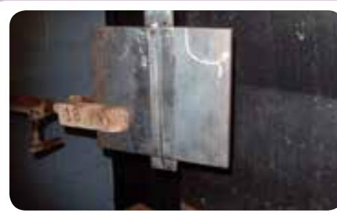
۳- قطعه کار را در وضعیت مناسب روی میز کار بیندید و با رعایت نکات ایمنی شروع به جوشکاری نمایید. (در صورت لزوم از مریخ خود مشورت بگیرید).
