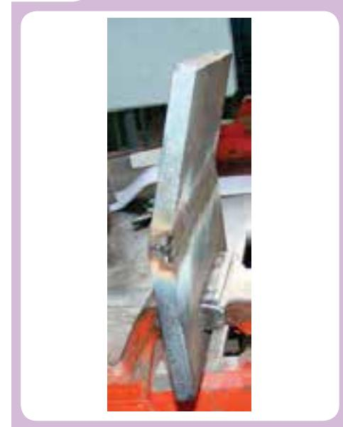
دو قطعه کار با ضخامت حدود ۱۵ میلی متر در اثر جوشکاری با طرح اتصال V حدود ۲۰ درجه دچار پیچیدگی زاویه ای شده اند.
